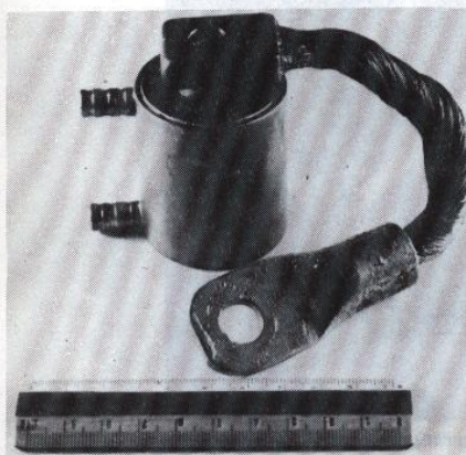
Rys. 8. Diody germanowe dużej mocy o prądzie wyprostowanym 30 A, 50 A, 100 A ( U_{BR} \leq 150 V)
